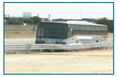
**Ensaio TB 51** Ônibus 13.000 kg, a 70 km/h e 20°
